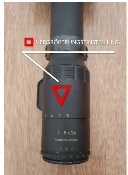
Abb. 8 Vergrößerungseinstellung eines MINOX ZP8 In diesem Fall hat das Zielfernrohr eine maximale Vergrößerung von 8.
